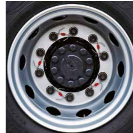
Témoin de chauffe
