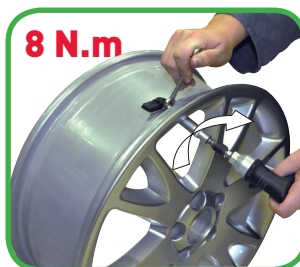
Respecter les couples de serrage Apply the recommended tightness torque
