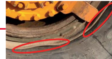
Utilisation de matériel non-conforme = DÉFORMATION DES ÉLÉMENTS DE LA JANTE
