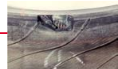
Détérioration et arrachement du talon OUTILLAGE INAPPROPRIÉ = RISQUE DE PNEU HS
