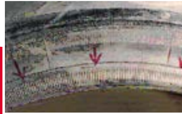
Mauvais positionnement du talon sur la jante
