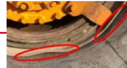
Utilisation de matériel non-conforme = DÉFORMATION DES ÉLÉMENTS DE LA JANTE
